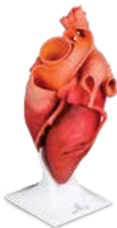
이 심장 모양처럼 복잡한 모델도 3D Systems CJP 프린터의 그라디언트를 사용하여 프린트할 수 있습니다
