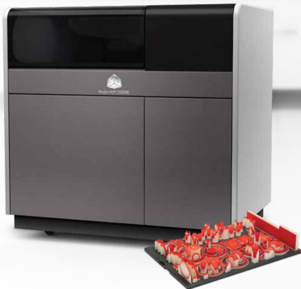
A solução de impressão completa Multijet da 3D Systems para fundição de joias inclui a impressora ProJet MJP 2500 3D, o software e os materiais necessários para gerar padrões de fundição 100% em cera sacrificial para uma produção de joias de alta capacidade de forma rápida, precisa e com microdetalhes. Tudo isso sem tempo de ferramental, custos e limitações geométricas, com eficiência de fundição de metal direta confiável e repetível.
