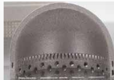
Cúpula com 15 mm de diâmetro impressa sem suportes
