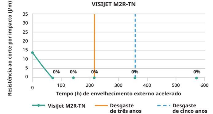
**ESTABILIDADE EXTERNA:** testada pelo método padrão ASTM G154.
