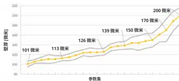
可定制壁厚的广泛参数数据库 十分可靠, 精确至 100 微米。 2
