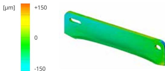
**Alta precisione** dopo la rimozione del supporto e la sabbiatura in base alle misurazioni rilevate mediante scansione 3D.
