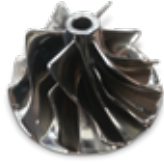
Reator em miniatura para teste de escala construído em LaserForm 17-4PH (A)
