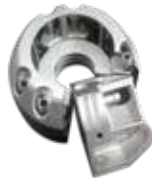
Molde de sopro com orifícios de conformação em aço Maraging LaserForm (B)
